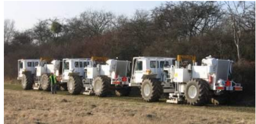
Wärme im Untergrund: Vibrationsfahrzeuge nutzen Schallwellen bei der Suche und der Analyse von wärmeführenden Schichten.
